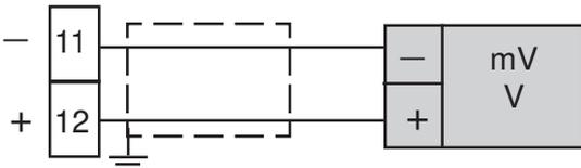
Fig. 7 V / mV input wiring
